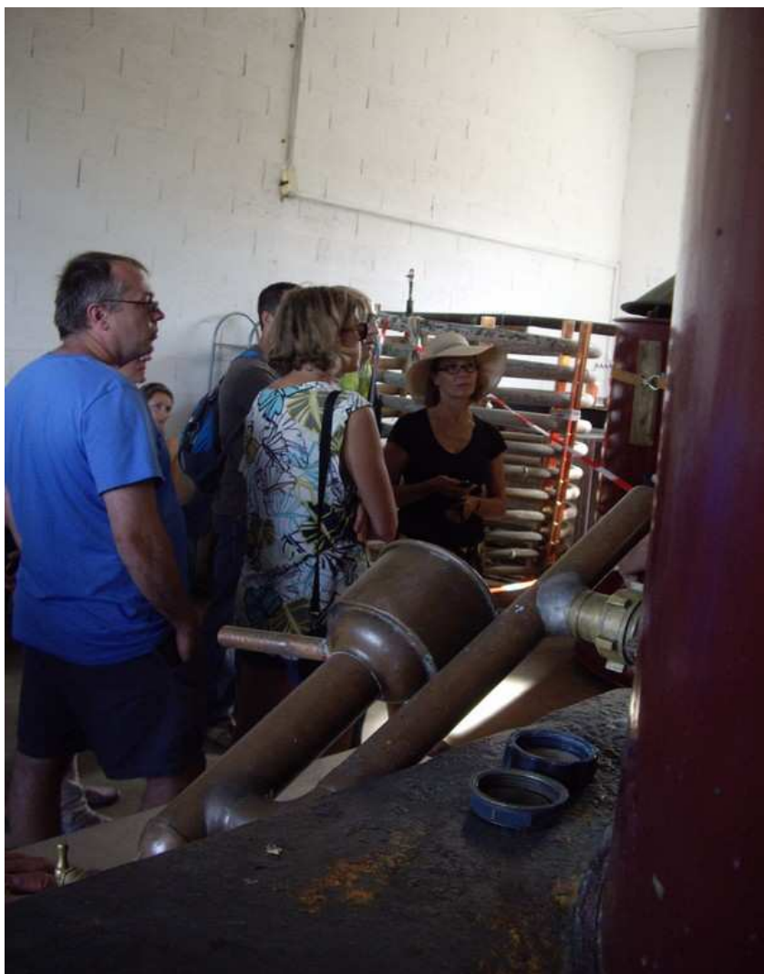
le serpentín sorti de sa cuve (au fond)
